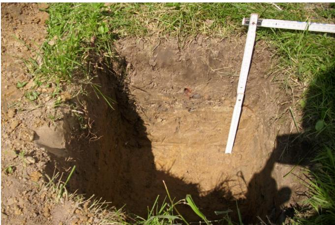
Bild 1: Kleine Grube für Versickerungstest vorbereitet (40 x 40 x 40 cm)
